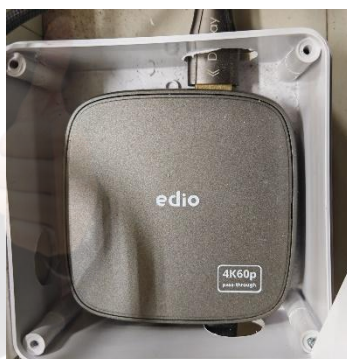
ภาพที่ 65 เชื่อมต่อสาย HDMI ที่หลุดจากกล่องสลับสัญญาณ ให้เรียบร้อย
