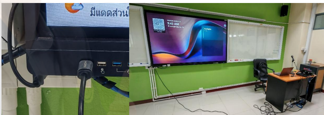
ภาพที่ 56 การเชื่อมต่อโดยตรงระหว่าง คอมพิวเตอร์ Notebook กับหน้าจอแสดงผลหลักอัจฉริยะ
